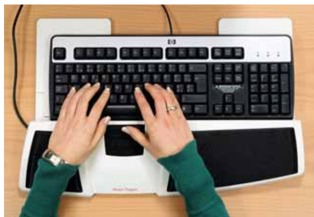
Fig. 17: Cette souris spéciale placée devant le clavier s'utilise avec les deux pouces.
